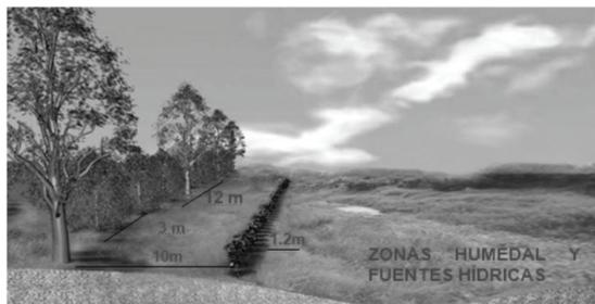
**Figura 3.** Implementación de trinchos con barreras vivas.
